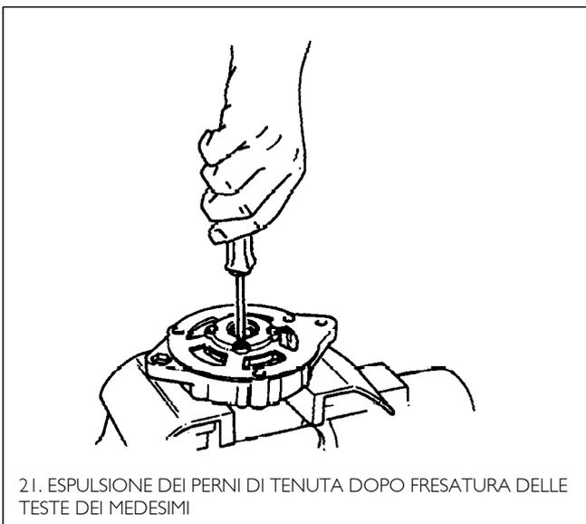
21. ESPULSIONE DEI PERNI DI TENUTA DOPO FRESATURA DELLE TESTE DEI MEDESIMI
